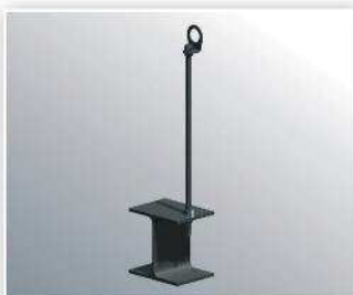
Einschrauben in Stahlträger • Randabstand mind. 30 mm • Mindest-Trägerbreite 130 mm Höhe Dachaufbau: Max. 350 mm Stützenhöhe: Max. 500 mm
