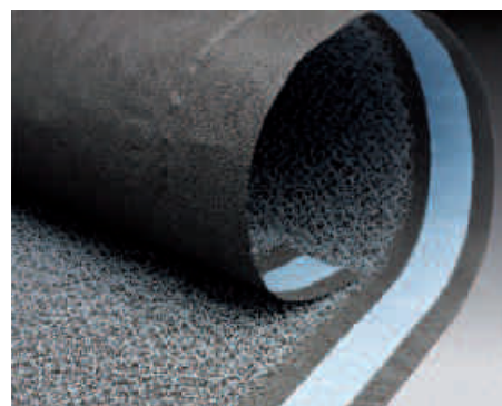
VAPOZINC® – Die strukturierte Trennlage von RHEINZINK mit dampfdurchlässiger Folie und doppelseitigem Nahtselbstklebe- band
